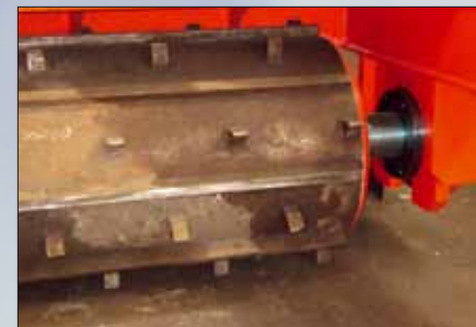
Particolare rullo di alimentazione
